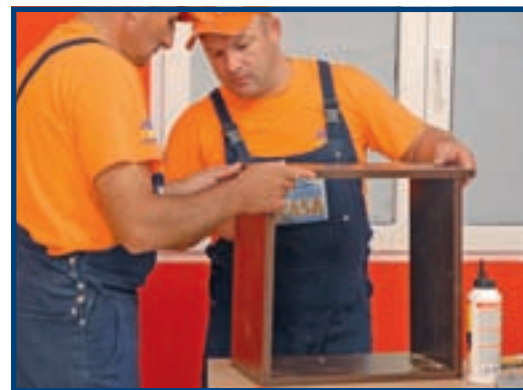
9 Urmează, logic, asamblarea ultimei piese a ramei. Muchiile laterale se înscriu, câte 4, în același plan.
