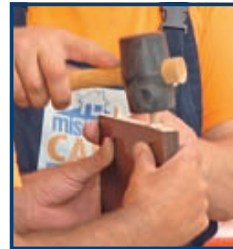
5 Se folosește ciocanul, dar fără a forța, deoarece PAL-ul melaminat poate ceda.
