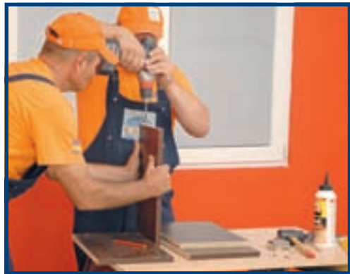
3 Găurile se execută întâi pe fețele melaminate, apoi în muchiile neprotejate ale plăcilor.
