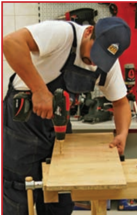
11 Acum se poate trece la montarea rafturilor pe panourile laterale. Procedurile sunt similare: execuția orificiilor și fixarea în șuruburi.
