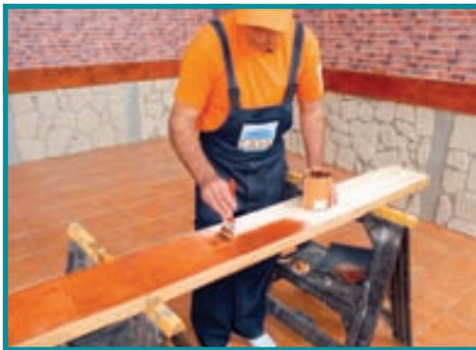
22. Abia după ce lemnul a fost tratat corespunzător suprafața grunduită se poate vopsi cu lac pentru lemn.
