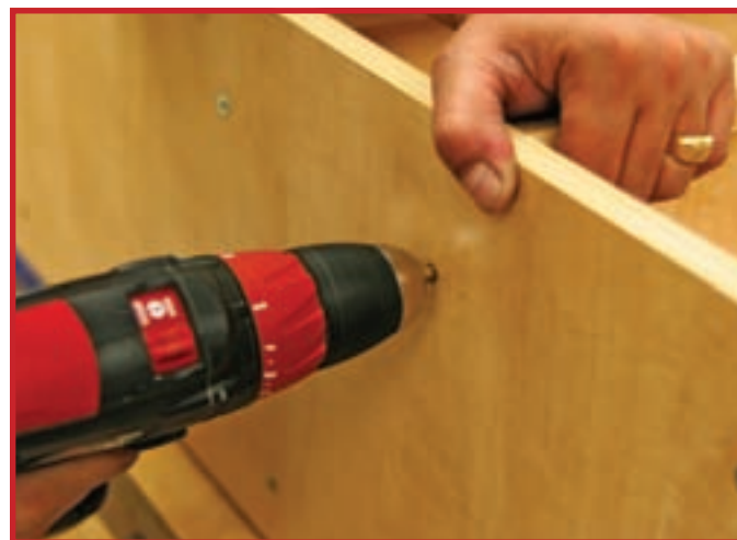
14 Pentru ca șuruburile să intre în mijlocul cantului lateral al raftului, executați orificiul și, pe partea opusă, demarcați cu un creion cotele între care vor trebui să se încadreze muchiile cantului.
