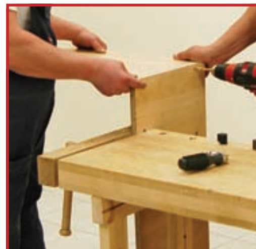
12 Se începe cu raftul superior, de dimensiuni similare, dar care nu are prevăzută o margine traforată pentru sticle.
