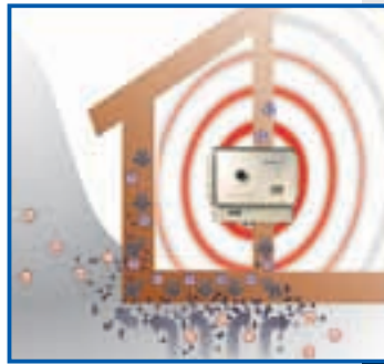
Emițătorul de unde electrice anulează efectul capilarității, iar umezeala dispare.
