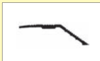
7. Trecere rigidă între două niveluri pentru trafic intens, cu găuri necesare fixării
